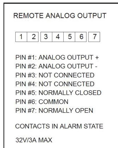
**Abbildung 2. Pin-Konfiguration Fernalarm**
